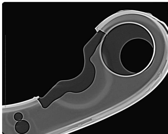
*Radiografia particolare sospensione saldato con filo animato HOBART FABCOR® F6 a velocità di avanzamento 1200 mm/min*
